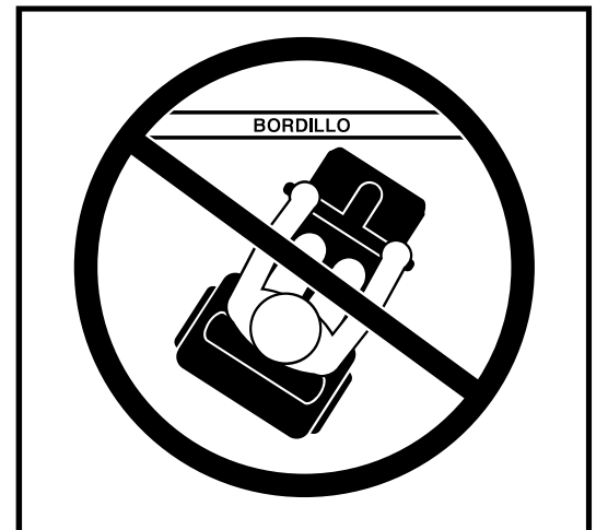
Figura 7. Modo incorrecto de subir/bajar un cordón
