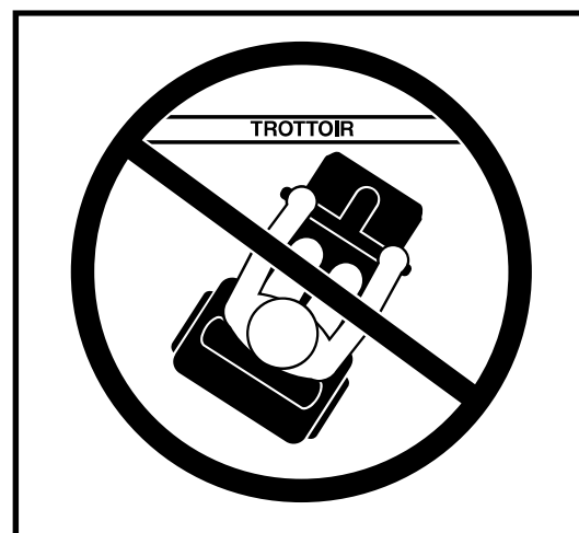
Figure 7. Approche incorrecte de trottoir
